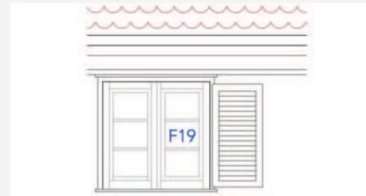
Fenster F19, 2-flügelig, Element zur Giebelseite, wird vorrangig im OG verwendet, schließt an Traufe an
