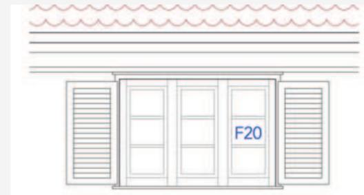
Fenster F20, 3-flügelig, Element zur Straßenseite, wird vorrangig im OG verwendet, schließt an Traufe an
