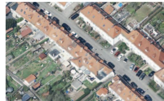
Abb. 65: Der Auszug aus dem Luftbild zeigt die Dachlandschaft der Gebäude an der Uhlandstraße. Deutlich sichtbar sind die diversen Einbauten auf dem Dach (z.B. Gauben, Dachflächenfenster, Satellitenanlagen, etc.). Flächen für Energiegewinnungsanlagen sind hier kaum noch möglich. Eine gute Alternative bieten die diversen Anbauten (siehe Bsp. in Abb. 66).
